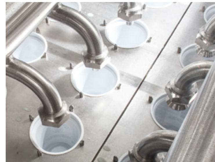
Abfüllmaschinen für verschiedene Hygienestufen, unterschiedliche Becherformate und Materialien.
