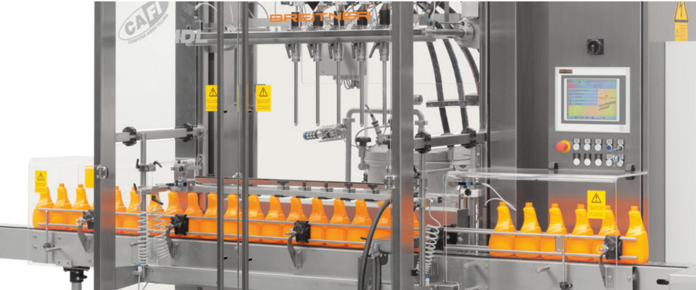
Hoher Hygiene-Standard: Leistungsfähige und universelle Linearfüller mit bis zu 16 Füllstellen und vollautomatische Verschließmaschinen für komplizierte Verschlüsse mit Steigrohren.
