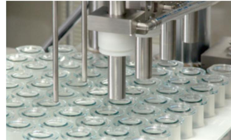
Füllmaschine für Fertigspritzen. Weitere Behältertypen – Karpulen und Vials – können auf der flexiblen Anlage verarbeitet werden.
